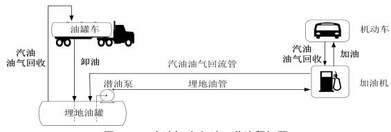
图 2.6-1 汽油卸油/加油工艺流程框图
