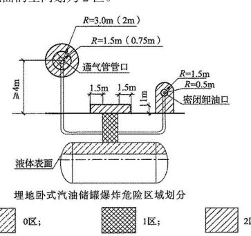
图 3.6-2 埋地卧式汽油储罐爆炸危险区域划分图
