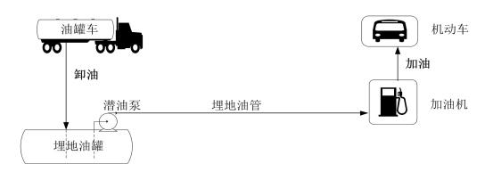
F图 1.2-2 柴油卸油、加油工艺流程图
