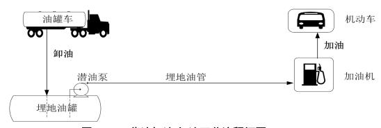
图 2.6-2 柴油卸油/加油工艺流程框图
