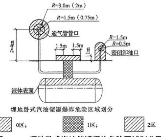
F图 1.3-2 埋地卧式汽油储罐爆炸危险区域划分图
