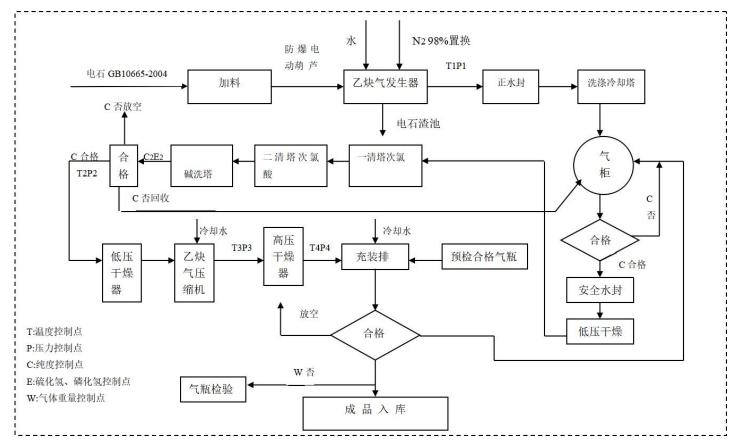
图 2-2 溶解乙炔生产工艺流程示意图
