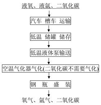
图 2-2 工业气体气化充装工艺流程示意图
