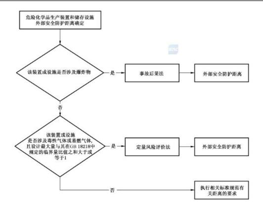
图 4.2.5-1 外部安全防护距离确定流程图
